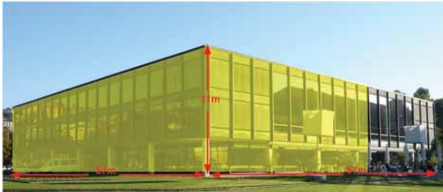
Behmel 15.02.13 Anlage 6: Das GKN auf Fels gebaut? Landtag von Baden-Württemberg 57 \times 57 \times 11 \text{ m} = 35.739 \text{ m}^3 Gipsauslaugung unter den Kernkraftwerken Neckarwestheim 1962 bis 2012: 18.600 \text{ m}^3 Hohlraum-Zunahme unter den Anlagen weiterhin jährlich 350 \text{ m}^3
